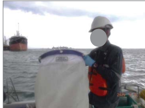
ถุงแพลงก์ตอนขนาดตา 330 ไมครอน สำหรับเก็บตัวอย่างแพลงก์ตอนสัตว์ขนาดใหญ่
