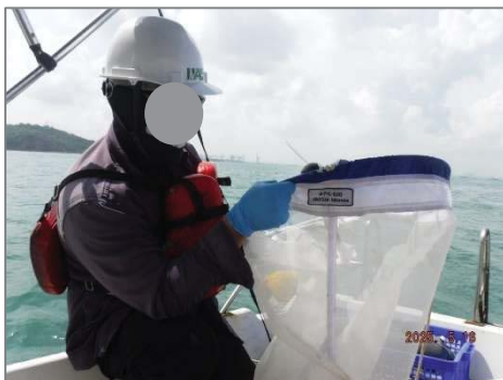
ถุง Larvae Net ซึ่งประกอบด้วยขนาดตา 2 ขนาด ภายในถุงเดียวกัน คือ ขนาดตา 550 ไมครอน (ส่วนบน) และขนาดตา 330 ไมครอน (ส่วนปลาย)
