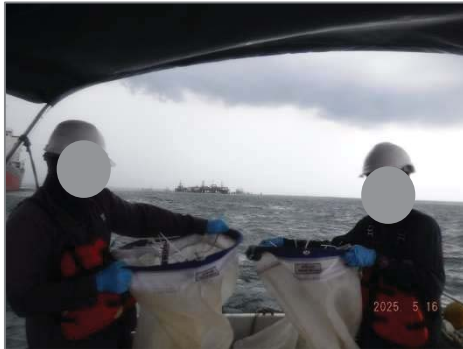
ถุงแพลงก์ตอนขนาดตา 100 ไมครอน สำหรับเก็บตัวอย่างแพลงก์ตอนสัตว์
