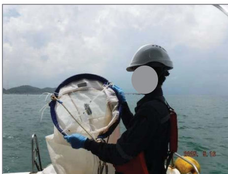
การติดตั้งวัดอัตราการไหล (Flow Meter) บริเวณกึ่งกลางปากถุง
