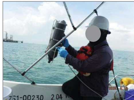
การเก็บตัวอย่างแพลงก์ตอนพืชด้วยกระบอกเก็บน้ำ
